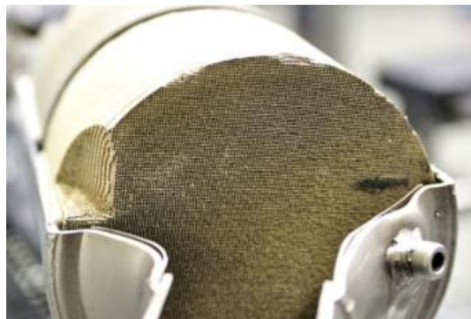
Figure 39. Structure en nid d'abeille d'un catalyseur
