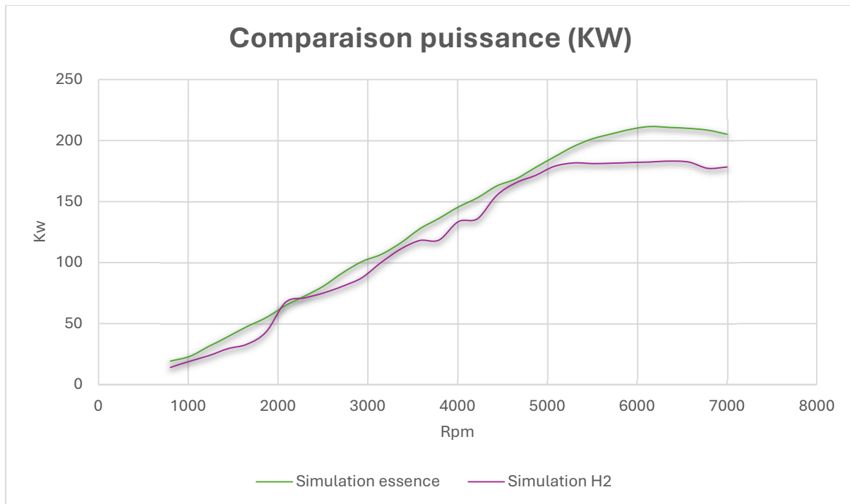
Figure 10 - Comparaison des courbes de puissance Essence et H2
